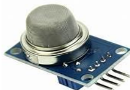
Fig. c) LPG Gas Sensor Module
